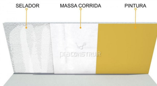
Figura 6 - Ilustração Aplicação Fundo Selador, Massa Corrida e Pintura (fonte: Autora/2020)
