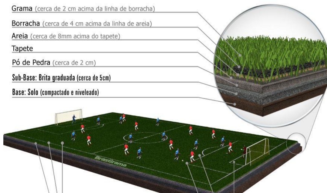
Figura 06 – Detalhe Ilustrativo de Instalação e Revestimento (Grama Sintética)
